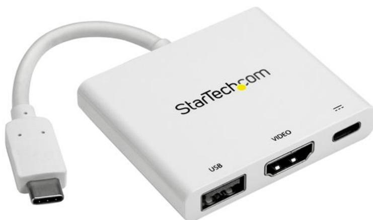
Este adaptador universal multifunción le permite expandir la conectividad de su laptop o MacBook a través de USB-C™. Puede conectar su laptop a una pantalla HDMI® 4K, pero además conectar un dispositivo USB 3.0 convencional. Cuando el adaptador multifunción se empareja con el adaptador de alimentación de su laptop ofrece el suministro de alimentación para cargar y mantener la batería de su laptop.
